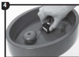
4. Scufundați pompa sub apă, dar fără tubul atașat. Apoi glisați-o de câteva ori înainte și înapoi, astfel încât pompa să elibereze aer.
