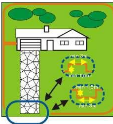
Ohraničení celé zahrady kromě příjezdové brány. V těchto místech se drát vyvede nad bránu nebo zakope do země a tím se přijímač obojku dostane mimo vysílaný signál z drátu.
