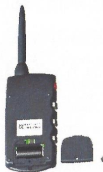
Obr. 8 – Wymiana baterii w nadajniku CANICOM 800
