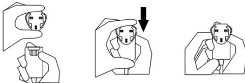
Pripojte priložený USB kábel s A/C adaptérom. Následne pripevnite dobijaciu svorku na zariadenie (p. obrázok).
