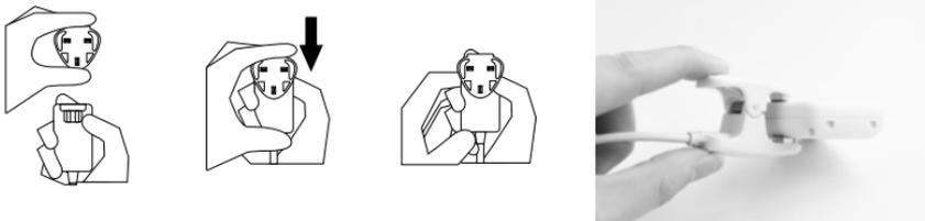
A continuación, sujete la pinza de carga en el dispositivo como se muestra en la siguiente imagen. El led en el dispositivo Tractive® GPS encenderá rojo cuando el dispositivo se esté cargando. Una vez que el dispositivo esté totalmente cargado la luz roja desaparecerá.
