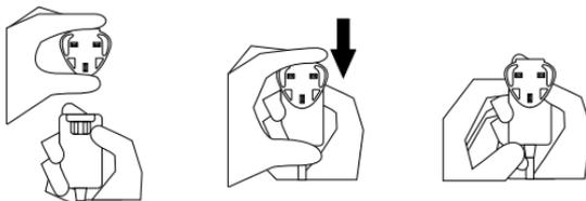
Csatlakoztassa a Tractive® GPS készülékhezkapott USB kábelt az adapterhez. Utána kapcsolja a töltő csattot a készülékhez az ábrán látható módon.
