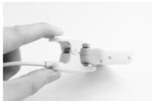
Kiinnitä USB-kaapeli laitteen mukana toimitettuun adapteriin ja liitä latauskiinnike laitteeseen kuvan mukaisesti. Tractive GPS-laitteen LED-valo palaa punaisena laitteen latautuessa. Kun laite on täysin latautunut, valo sammuu.
