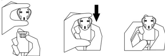
Propojte přiložený USB kabel s A/C adaptérem. Poté připevněte dobíjecí svorku na zařízení (viz. obrázek).
