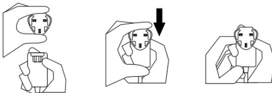
Podłącz kabel USB do ładowarki, którą otrzymałeś/aś razem z urządzeniem Tractive® GPS. Potem podłącz klipsa do urządzenia, tak jak w obrazku poniżej.
