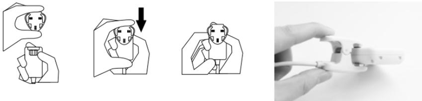
Om het toestel te laden verbindt u de klem van de laadkabel met het toestel zoals in de volgende afbeelding weergegeven.
