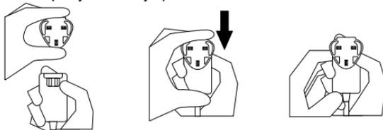
Spojite USB kabel na A/C punjač koji je došao sa Tractive® GPS uređajem. Nakon toga spojite hvataljku za punjenje na uređaj kako je prikazano na slici.
