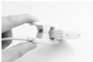
Mens lading av Tractive GPS trackeren pågår, lyser LED-indikatoren rødt. Etter lading slokner LED-indikatoren, som betyr ferdig ladet batteri.
