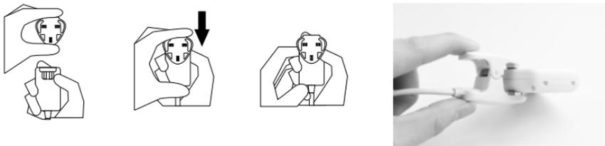
Ligue o cabo USB a um adaptador / C Isso veio com o dispositivo Tractive® GPS. Em seguida, anexar a braçadeira no dispositivo de carga como mostra na imagem abaixo.
