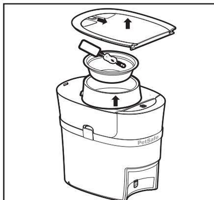
2. Doporučujeme umýt a vypláchnout misku, držák misky, násypku, víko a dopravník. Když jsou díly suché, ujistěte se, že okraj dopravníku je zarovnan s šípkami na boku. Vyměňte dopravník a zásobník na krmivo.
