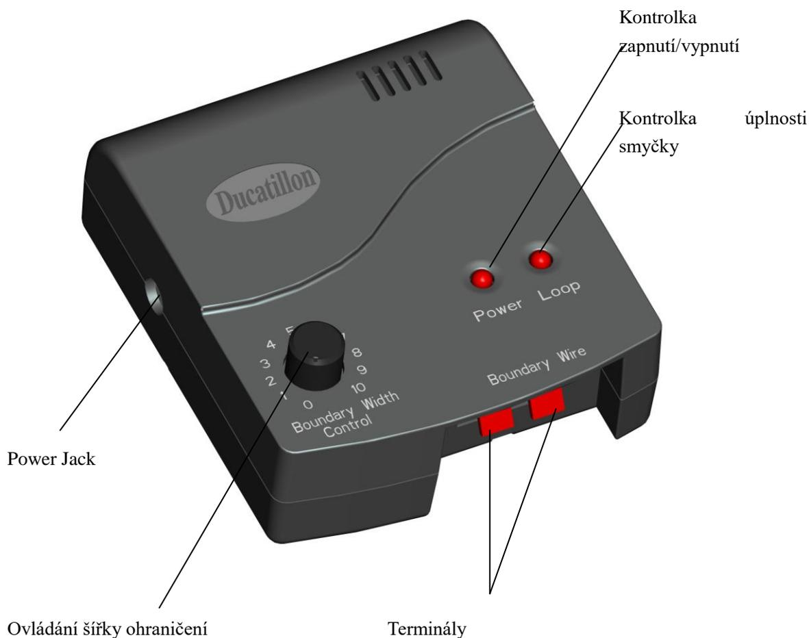
**Ovládání šířky ohraničení :** Nastavení šířky ohraničení--- kombinace výstražné zóny a zóny statické korekce.
