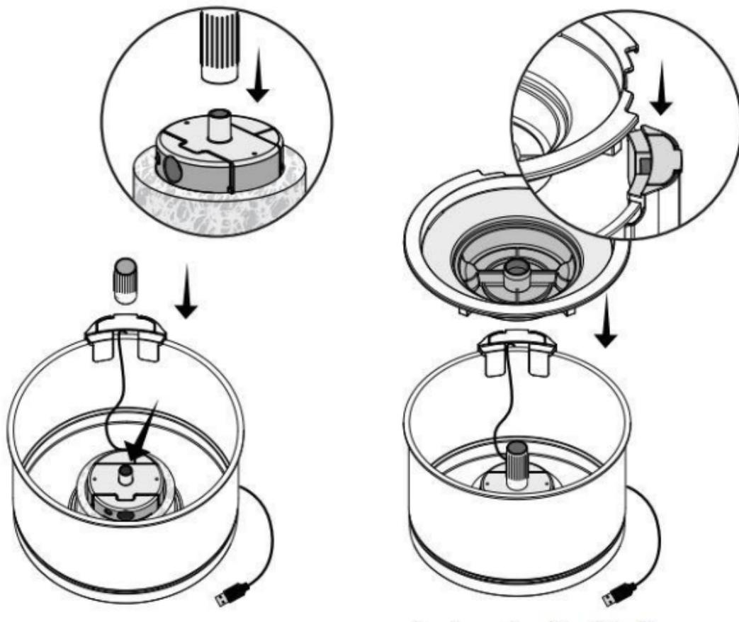
1. Richten Sie das Auslassrohr an der Wasserpumpe aus und drücken Sie
