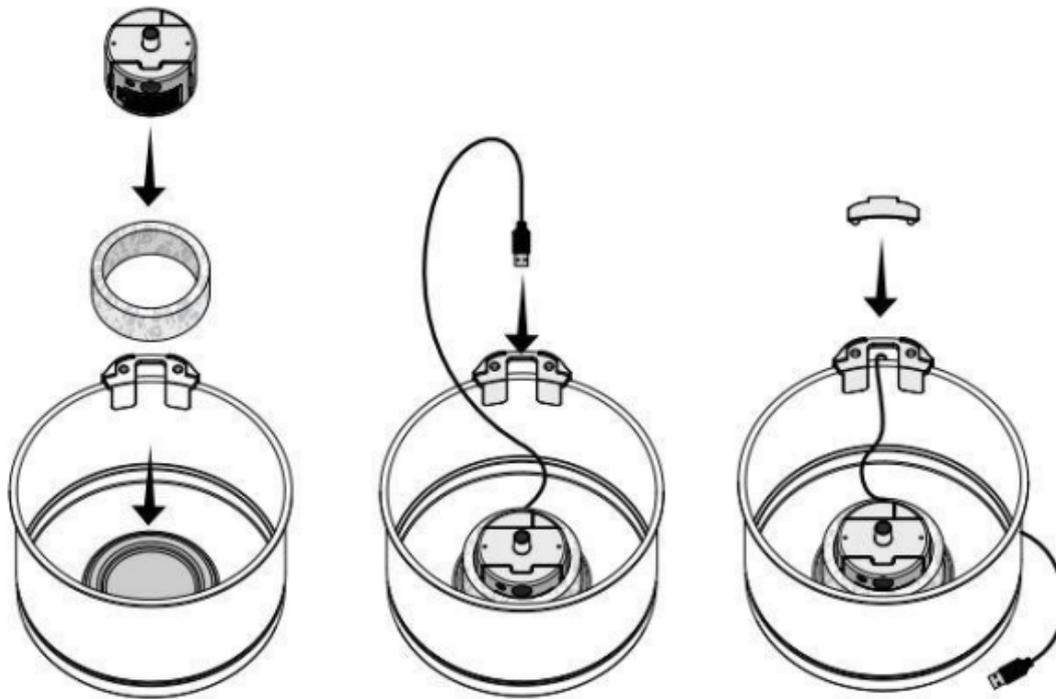
1. Setzen Sie die Pumpe in den Schaumfilter und legen Sie beide in eine Runde platz im Inneren des Brunnens. Drücken Sie nach unten, um Saugnäpfe zu machen befestigen
