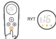
**3** **Funkce zvuku:** stiskněte tlačítko zvuku, přijímač vydá pípnutí. Dlouhým stisknutím tlačítka zvuku provedete funkci bez přerušení.
