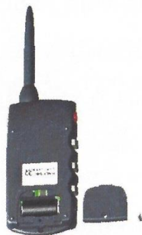
Obr.8 – Výměna baterie u ovladače CANICOM 800
