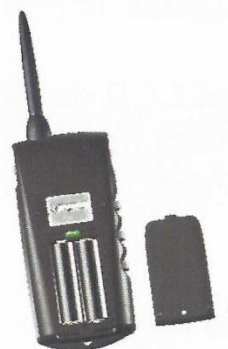
Obr.9 – Výměna baterií u ovladače CANICOM 1500
