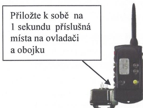
Obr.6 – Zapnutí/vypnutí obojku ovladačem CANICOM 800
