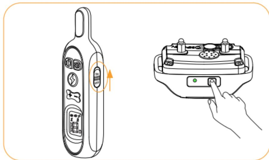
Třikrát stiskněte tlačítko napájení na přijímači pro vstup do režimu párování. Uslyšíte varovný tón a indikátor se rozsvítí. Nyní budete mít 10 sekund na dokončení párování.
