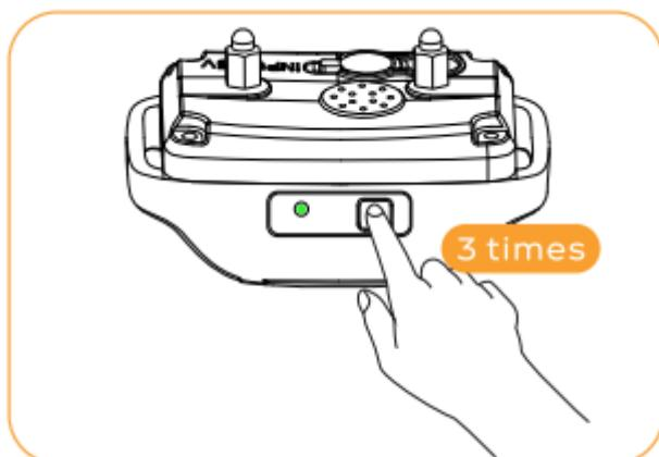
Stiskněte tlačítko výstražného zvuku, vibrační tlačítko nebo tlačítko impulsu na dálkovém vysílači a přijímač odpovídajícím způsobem zareaguje, což znamená, že proces párování byl dokončen.
