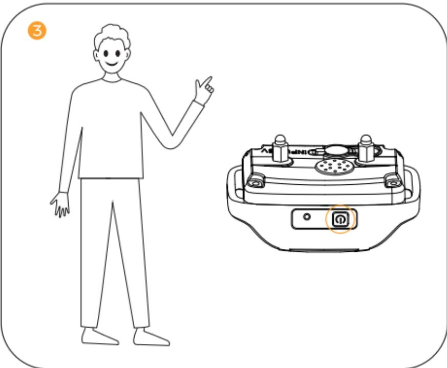
Zapněte přijímač stisknutím a podržením tlačítka napájení po dobu 2 sekund.
