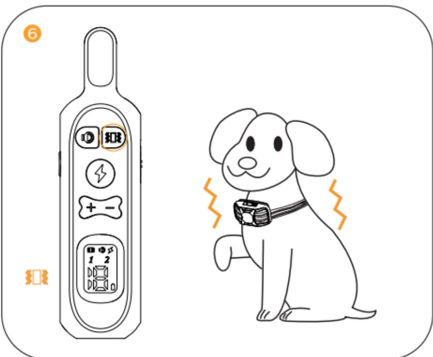
Vibrace: stiskněte tlačítko Vibrace a přijímač vydá vibrace. Stisknutím tlačítka Level upravíte úrovně vibrací.
