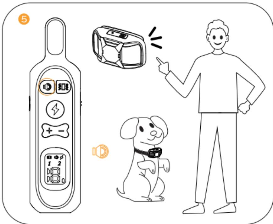
Příkaz zvukové korekce: stiskněte tlačítko zvuku a přijímač vydá varovný tón.
