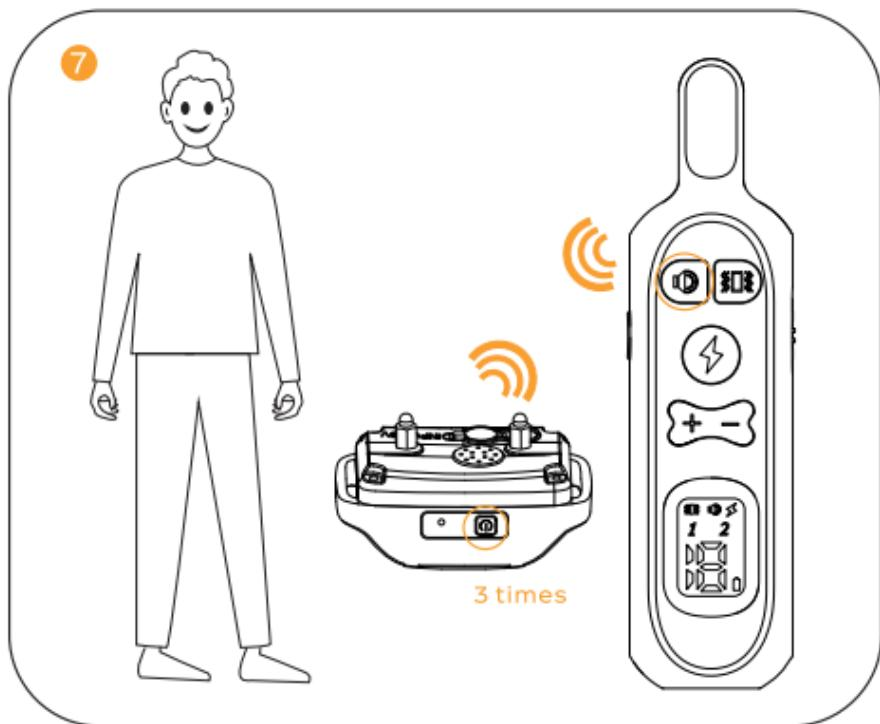
Spárujte výrobek s dalším přijímačem: stiskněte 3x tlačítko napájení na přijímači, dokud neuslyšíte pípnutí, poté stiskněte libovolné z tlačítek korekce impulsu, vibrace nebo zvuku a přijímač zareaguje.
