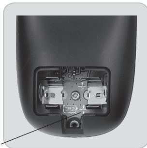
Kennzeichnung der Batteriepolarität
