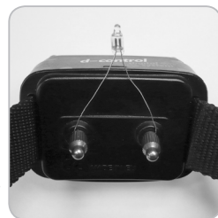
Bild: Befestigung der Neon-Teströhre
