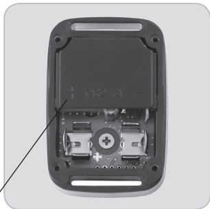
Kennzeichnung der Batteriepolarität
