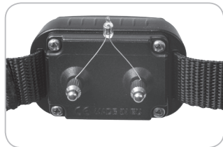
Fixierung der Neonprüfrohrendrähte an die Kontakte
