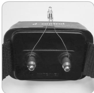
*Bild: Befestigung der Neon-Teströhre*
