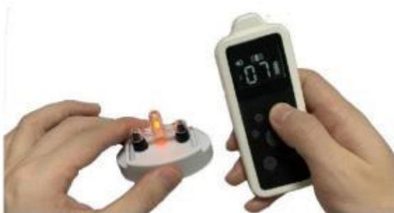
4. Wenn der Empfänger funktioniert, wird er nach 2 Minuten in den Ruhezustand versetzt. Drücken Sie eine beliebige Taste auf der Fernbedienung, um ihn wieder zu aktivieren.
