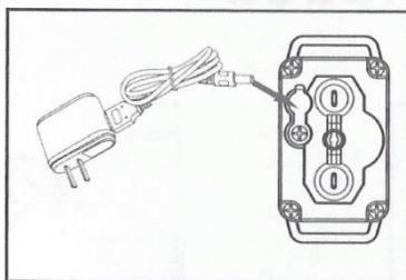
**Tip:** Pri prvých troch nabíjaniach nabíjajte vysielačku a prijímač aspoň 4 hodiny .
