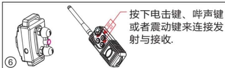
**第六步:**连接发射和接收。首先同时按发射上的三个功能键将发射开机。按训狗模式键选择不同训狗模式(模式1,模式2或者模式3)。选择模式1后再按前面三个功能键来控制第一个接收。在红灯熄灭的同时蓝灯会开始闪烁。如果您购买了可供两只狗的训练接收,将它开机,然后选择模式2再按任何功能键可将它与发射连接。之后,您就可以分别用不同的训狗模式来训练不同的狗了。选择模式3表示可同时控制两只狗。
