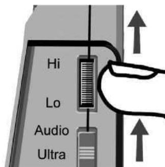
Drehen Sie den Knopf, bis er eine Vierteldrehung über der „Lo“-Position steht. Bitte drehen Sie den Knopf nicht auf die Position „Lo“ – mit dieser Einstellung erkennt das Gerät überhaupt kein Bellen. Warten Sie, bis der Hund natürlich bellt (erzwingen Sie es nicht) und beobachten Sie, ob das Gerät aktiviert wird.
