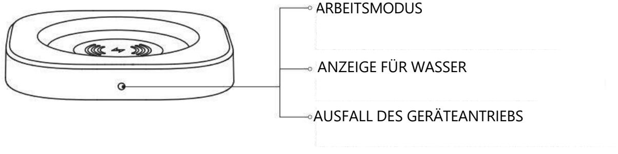
**ARBEITSMODUS** – Kein Licht an: Ununterbrochener Wasseraustritt. (Wasser fließt standardmäßig nach dem Einschalten aus: das grüne Licht blinkt 3 Mal, nachdem der Strom eingeschaltet wurde)
