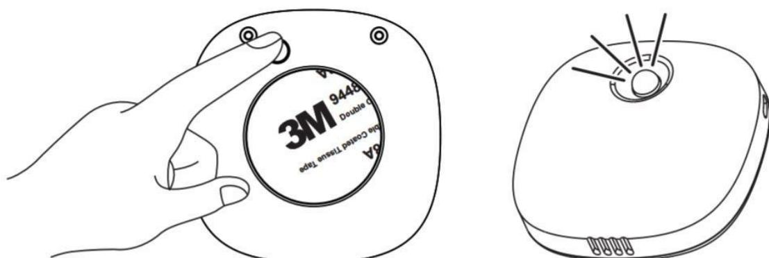
3. Ziehen Sie den 3M-Aufkleber auf der Rückseite ab, platzieren Sie den Luftauslass nach unten, kleben Sie ihn an die gewünschte Stelle und drücken Sie ihn 10 Sekunden lang gleichmäßig an, um ihn zu befestigen.
