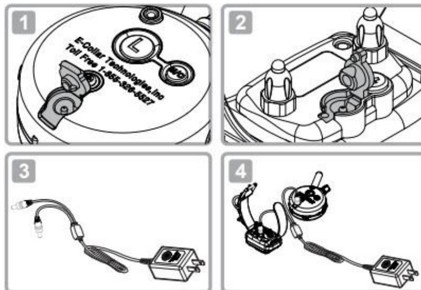
Die Anzeige leuchtet während des Ladevorgangs rot. Sobald das Gerät vollständig aufgeladen ist, leuchtet sie grün (ca. 2 Stunden).
