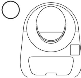
2. Stellen Sie das Gerät in der Nähe einer Steckdose auf. Achten Sie darauf, dass das Gerät nicht gegen eine Wand oder Ecke gedrückt wird (es darf die Wände nicht berühren) und dass keine anderen Gegenstände darauf liegen.
