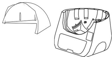
**7** Setzen Sie den Kohlefilterbehälter nach der Reinigung wieder in die Abfallschublade ein und montieren Sie das Tablett wie vorgeschrieben.
