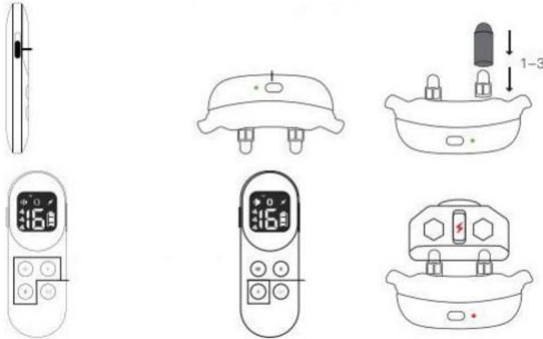
Drücken Sie eine beliebige Taste, um den Sender zu aktivieren, drehen Sie den Schalter auf linke Seite des senders nach unten und entsperren die statische stimulation funktion. Ein drücken Sie die Power-Taste, um den Empfänger einzuschalten. Installieren Sie auf dem Empfänger elektroden und Gummikappen. Drücken Sie eine beliebige Funktionstaste (Vibration, puls, ton) auf der fernbedienung und der empfänger wird die entsprechende ausgabe Korrektur.
