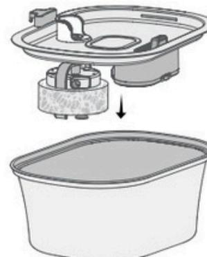
Setzen Sie die Abdeckung wieder auf und drehen Sie sie, um sie zu verriegeln.
