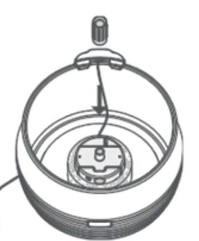
Richten Sie das Auslassrohr mit dem Auslass der Wasserpumpe aus und drücken Sie es fest.
