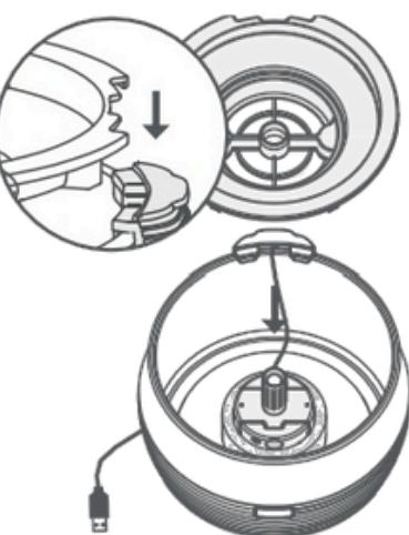
Richten Sie die Kerbe aus und setzen Sie den Filterträger ein.
