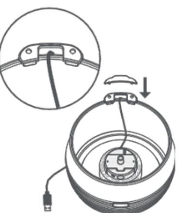
Führen Sie das USB-Kabel nach unten in das Loch in der Halterung und durch die Aussparungen an der Unterseite der Halterung heraus. Bringen Sie die Kabelabdeckung und den Halter wieder an. Bringen Sie die Kabelabdeckung wieder an, die das Kabel festhält.
