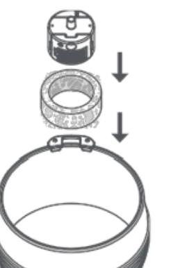
Setzen Sie die Pumpe in den Schaumstofffilter ein und schieben Sie beides in die runde Schale. Drücken Sie sie nach unten, damit die Saugnäpfe einrasten.
