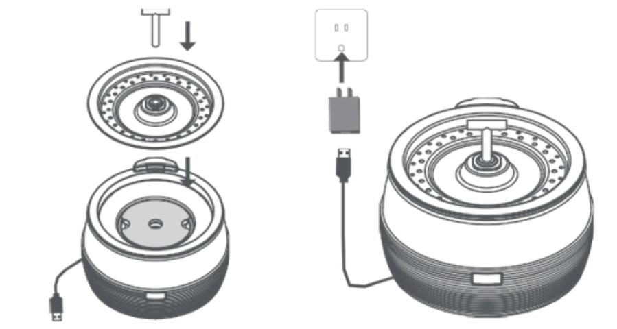
Bringen Sie den Deckel nach und nach an, T-Tap. Schließen Sie den Netzadapter an.
