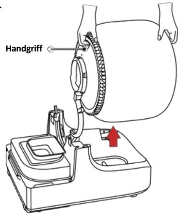
Setzen Sie die AI-Kamera in den Installationsanschluss ein. (wie auf dem Bild gezeigt)
