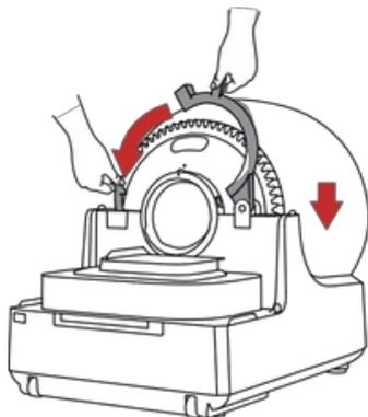
② Installieren Sie das Gerät und achten Sie darauf, zur Befestigung an den Magneten auf beiden Seiten.
