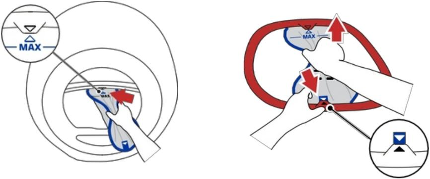
③ Drücken Sie die Unterlegscheibe vorsichtig zusammen und lassen Sie sie wieder los, so dass beide Seiten von selbst in die Nut gleiten.
