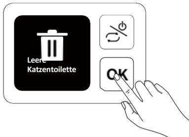
2 Wenn der Mülleimer während Entleerung voll, stoppt das Gerät die Entleerung und startet die automatische Verpackung. Entfernen Sie den eingewickelten Müllsack, nachdem Sie mit dem Packen begonnen haben. und drücken Sie dann zweimal OK Start bei automatische Nachfüllung.
