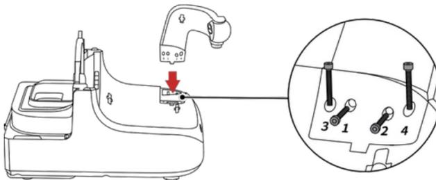
④ Setzen Sie den Zylinder auf die Basis und befestigen Sie den Verschluss, so dass er fest sitzt.
