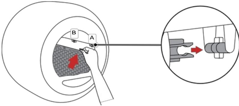
**5** Setzen Sie die Rolle auf die Basis, befestigen Sie die Schnalle und vergewissern Sie sich, dass die Schnalle geschlossen ist.
