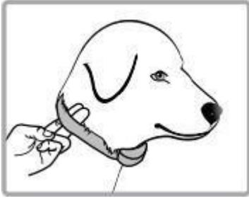
**Wichtig: Der korrekte Sitz und die richtige Positionierung des Halsbandes mit dem Empfänger ist wichtig für seine effektive Funktion. Die Kontaktstifte müssen in direktem Kontakt mit der Haut Ihres Hundes an der Unterseite des Halses sein.**
