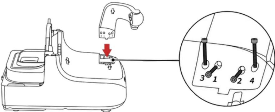
Coloque el cilindro en la base y asegure el clip para asegurarlo.
