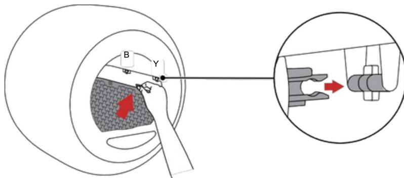
Coloque el cilindro en la base, asegure el clip y asegúrese de que esté colocado.
