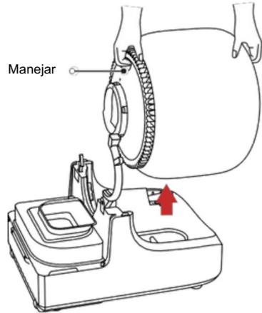
Inserte la cámara AI en el puerto de instalación.
