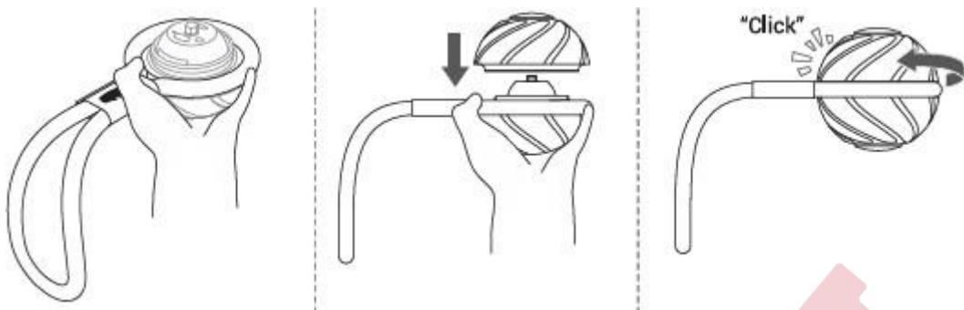
Halten Sie das Seil in Position. Ausrichten. Drücken und im Uhrzeigersinn drehen
