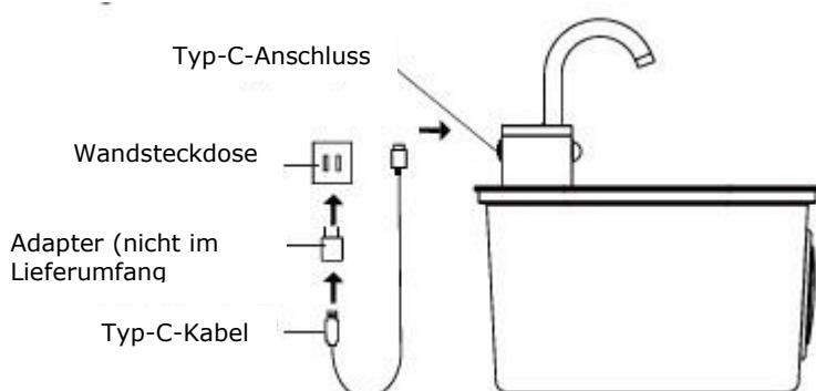
Wenn die Verwendung der Batterieversorgung nicht geeignet ist, ziehen Sie bitte das Datenkabel ab und schließen Sie die wasserdichte Abdeckung.
