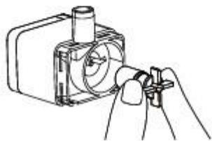
4. Reinigen Sie das Innere der Wasserpumpe und das Laufrad mit einer Bürste.
