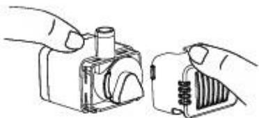
2. Entfernen Sie die Abdeckung des Laufrads. (Laufrad – also der rotierende Teil der Pumpe, der Wasser ansaugt und ausstößt, ein Teil mit Schaufeln, der sich dank des Motors dreht und für den Wasserfluss sorgt)
