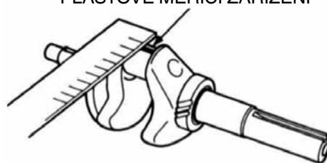
PLASTOVÉ MĚŘICÍ ZAŘÍZENÍ
