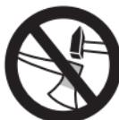
斧を金属製のクサビを打ち込むためのハンマーとして使用しないでください。
