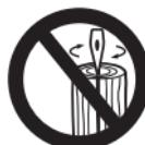
Üritage puidu lõhkumisel tabada alati puitploki keskkohta. Kui kirves on puidus kinni kiilunud: ärge suruge, lõäge ega kangutage vart kunagi küljele! Vars või lõiketera osa võib ära murduda. Selle asemel liigutage vart vertikaalselt ülespoole ja allapoole ning eemaldage kirves ettevaatlikult.
