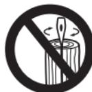
Skaldydami medieną visada stenkiteis pataikyti į rąstgalio vidurį. Jei kirvis įstrigo medienoje: Koto niekada nespauskite, nekalkite ir nekelkite į šoną! Kotas arba ašmenų dalis gali nulūžti. Vietoje to, kotą vertikalai judinkite aukštyn ir žemyn ir atsargiai išlaisvinkite kirvį.
