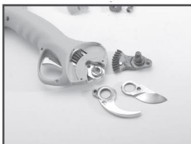
5. Odstraňte pevnou čepel
