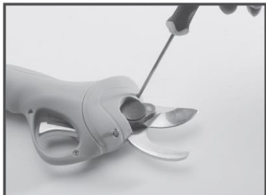
1. Odstraňte šrouby pomocí šroubováku a otevřete kryt
