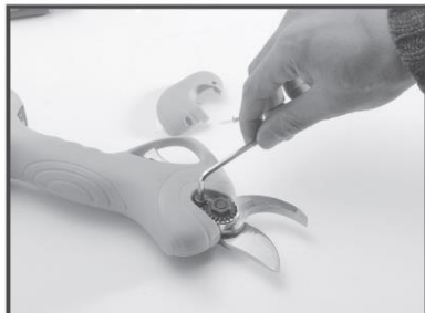
2. Odstraňte šrouby na čepu matice (tento krok je kritický) Odstraňte šrouby
