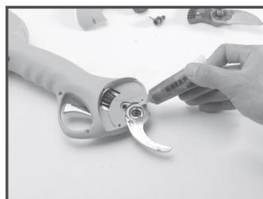
6. Při výměně nožů je nutné přidat olej
