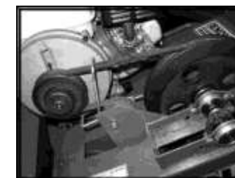
Obr.12: Správně namontovaný hnací řemen
