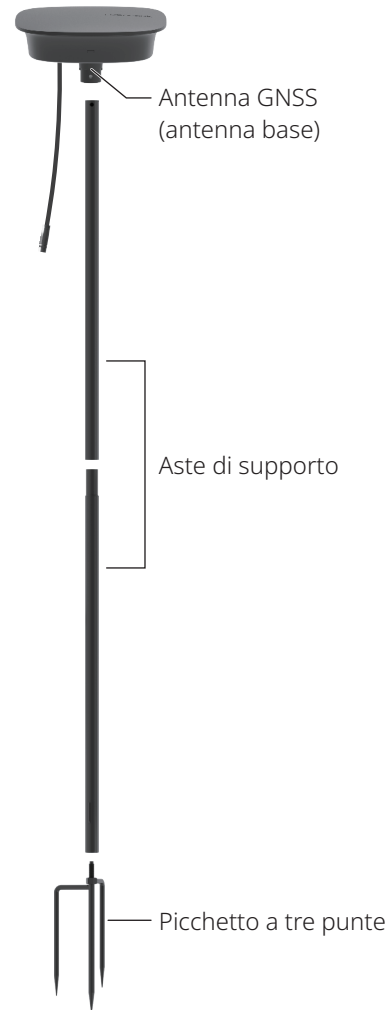
Stazione di riferimento RTK
