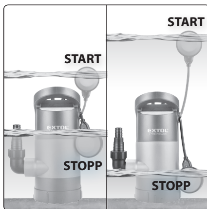
Abb. 4, Darstellung der Schwimmerschalterfunktion
