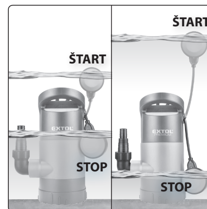
Obr. 4, ilustrácia funkcie plavákového spínača
