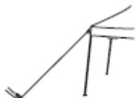
Připojte jeden konec každého lana k trojúhelníkovému držáku lana, který je umístěný na vnějším rohu tkanin. Vytáhněte lanko z rohu altánu směrem k zemi v úhlu 45 stupňů. Jedním z větších kolíků zajistěte lano. Ujistěte se, že lana jsou dostatečně napnutá.
