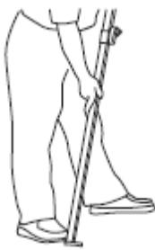
Unieś dwie sąsiadujące z nimi zewnętrzne nogi i ostrożnie usuń wewnętrzne nogi, aż sprężyna z przyciskiem spadnie do żądanej pozycji. Powtórz tę czynność dla następnych dwóch nóg. Altanka oferuje trzy poziomy wysokości. Aby wyregulować wysokość, podnieś stopę, ostrożnie naciśnij przycisk do golonki i powoli wyciągnij wewnętrzną nogę, aż przycisk zatrzasnie się na miejscu w następnej pozycji. Powtórz na innych nogach. Bądź ostrożny, nie przekraczaj maksymalnej wysokości.
