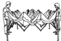
Každý partner by poté měl uchopit spodní část středního rámečku (příčné nosníky), které tvoří tvar diamantu. Mírně konstrukci zvedněte a pomalu ustupujte dozadu, dokud není rám zcela vytažen. Pozor na skřípnutí prstů!
