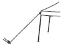
Przymocuj jeden koniec każdej liny do trójkątnego uchwytu linowego, który znajduje się na zewnętrznym rogu tkanin. Pociągnij kabel z rogu altanki w kierunku ziemi pod kątem 45 stopni. Zabezpiecz linię jednym z większych kołków. Upewnij się, że liny są wystarczająco zam szane.
