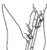
Zwolnij przycisk na każdej nodze i skróć długość stopy do jej pierwotnej wysokości, poprzednio używanej do wydłużenia nóg podczas regulacji.
