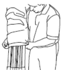
Helyezze a hajtогatott szerkezetet a földre, és húzza a védőburkolatot fentről lefelé. Óvatosan tegye fel a tárolózsákat, és húzza le. Ne helyezze a keretet a sérülések elkerülése érdekében. Tárolás előtt ellenőrizze, hogy a pavilon teljesen száraz-e.
