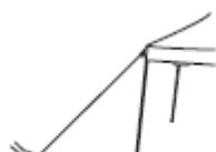
Pripevnite jeden koniec každého lana k trojuholníkovému držiaku lana, ktorý sa nachádza na vonkajšom rohu tkanín. Vytiahnite kábel z rohu altánku smerom k zemi pod uhlom 45 stupňov. Zaistite lano jedným z väčších kolíkov. Uistite sa, že laná sú dostatočne zatúlané.
