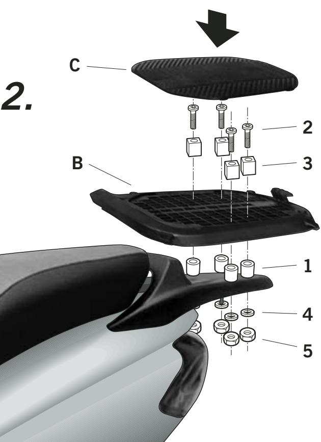
**(E)** **Consejo para un correcto montaje del kit:** No apretar los tornillos del todo hasta asegurarse que el KIT está correctamente colocado y alineado.
