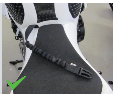
KROK 2: Připevněte na motocykl vytvořením jednoduché smyčky
