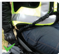
Installazione alla moto con un cappio
