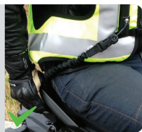
Installation à la moto avec un nœud coulant
