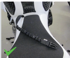
Installazione alla moto con un cappio
