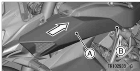
A. Kryt sacího potrubí
