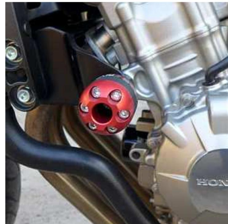
\* Při utahování šroubů přímo do závitu v bloku motoru používejte momentový klíč a nastavte dotahovací moment určený servisním manuálem Vašeho motocyklu!
