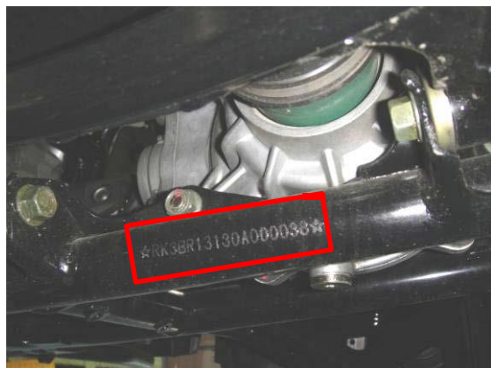
Umiestnenie čísla VIN (Vehicle Identification Number)
